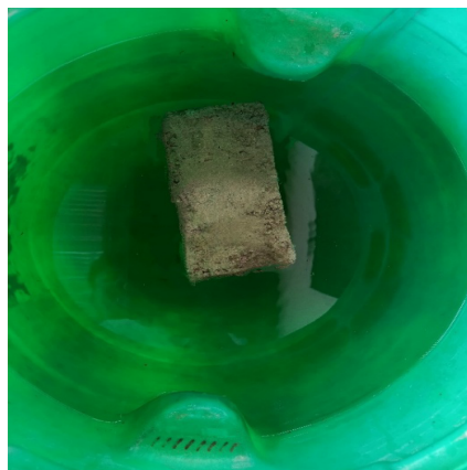
Figura 11. Muestra sumergida de bloque tradicional para ensayo de absorción
